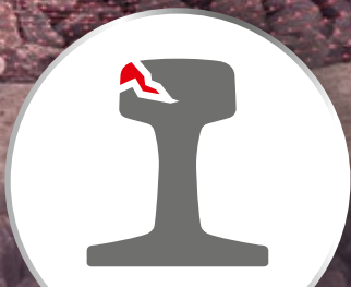
HEAD CHECKS (PARALELNÍ TRHLINY)
