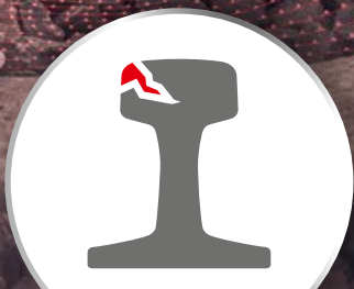
AGRIETAMIENTO DE CABEZA DE CARRIL
