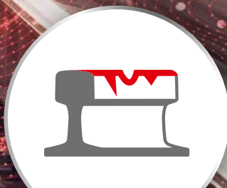
FISURAS EN CARRILES
