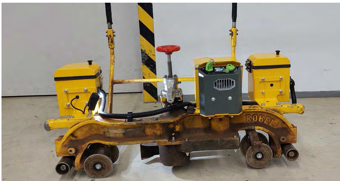
Afb. 7-1 gemonteerde Power Unit GPU 3400 +S op Robel 13.44/13.45
