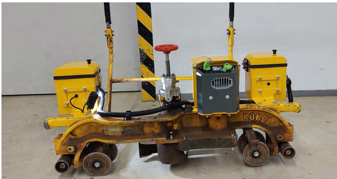
Afb. 3-2 gemonteerd Power Unit GPU 3400 +S op Robel 13.44/13.45
