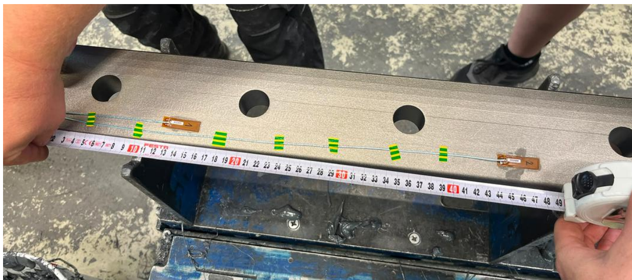
Obr. 4: MFC senzory zafixované připravené k lepení spojky
