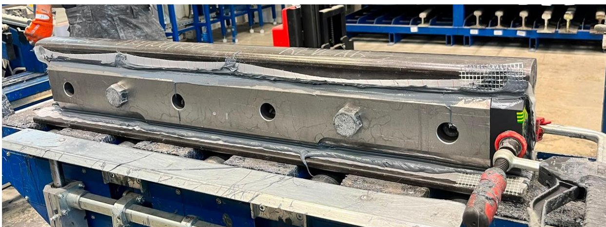
Obr. 7: Smontovaný celek v procesu tuhnutí a zrání
