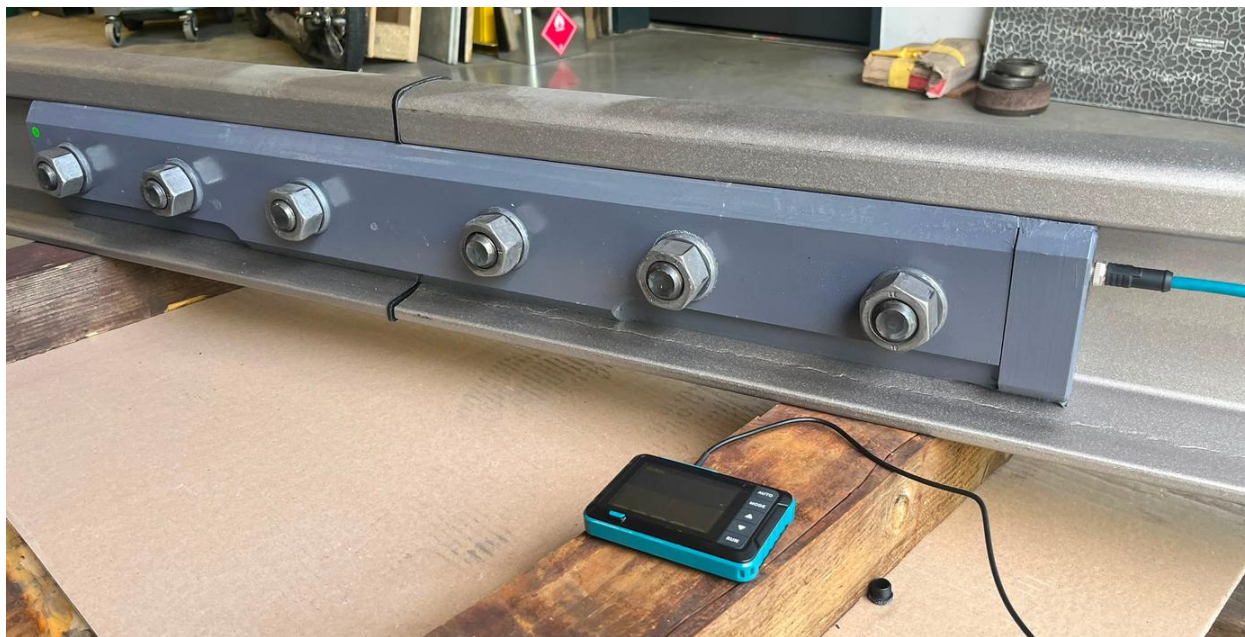
Obr. 8: Montáž hotového prototypu na kolejnici pro účely testování
