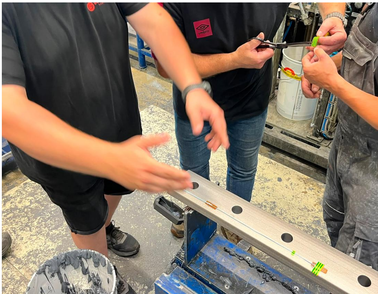
Obr. 3: Umisťování MFC senzorů na spojku
